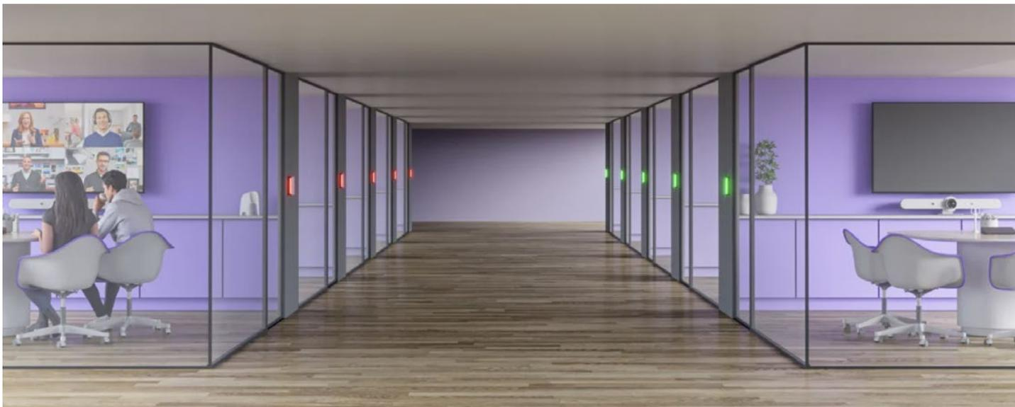
Avec Logitech Tap Scheduler installé à l'extérieur des salles de réunion, les employés peuvent voir facilement la disponibilité à distance. Les témoins lumineux sur le côté de l'appareil s'allument en rouge lorsque la salle est occupée, et en vert lorsqu'elle est libre.
